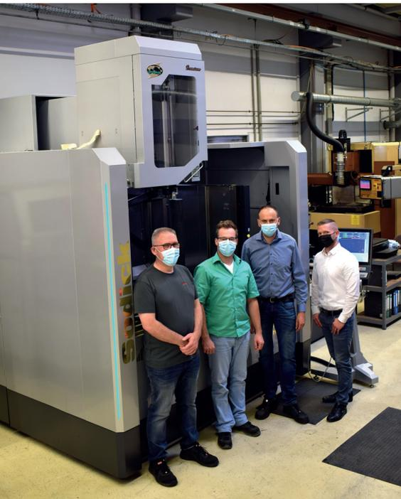
Bild 4: Der Vergleich mit dem Erodier-Team zeigt das Größenverhältnis der neuen ALC800GH Drahterodiermaschine mit 800 mm Schneidhöhe. V.l.n.r. Danny Seidler, Spezialist für Drahterosion, Jörg Roming, Abteilungsleiter Drahterosion, Markus Langenbacher, Geschäftsführer der bes Funkenerosion GmbH, Daniel Günzel, Gebietsverkaufsleiter BW der Sodick Deutschland GmbH
